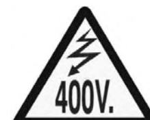
Imagen 21 Riesgo eléctrico 400 Voltios
