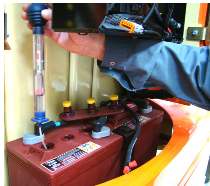
Figura 5-8. Medición de la gravedad específica del electrolito
