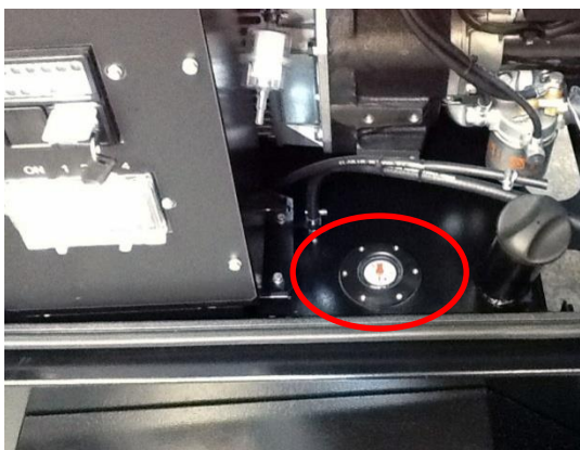
Situación del calibre del nivel de combustible
