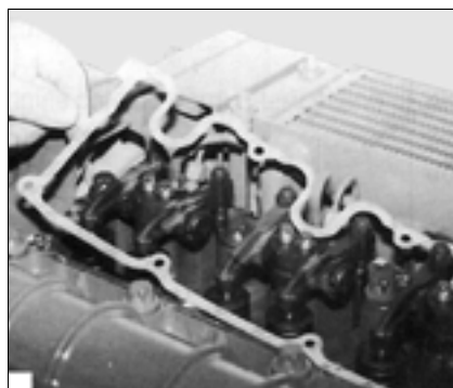
Fig. 4: Aplicar la junta del sombrerete de válvula
