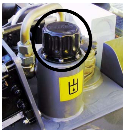
Fig. 19: Abertura de llenado de aceite hidráulico
