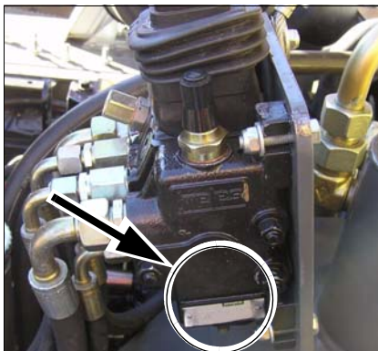
Fig. 5: Placa de identificación de la bomba hidráulica
